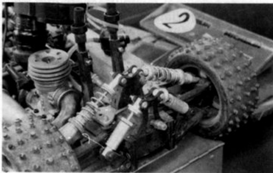
4 amortisseurs hydrauliques pour absorber les bosses de Grenoble.
