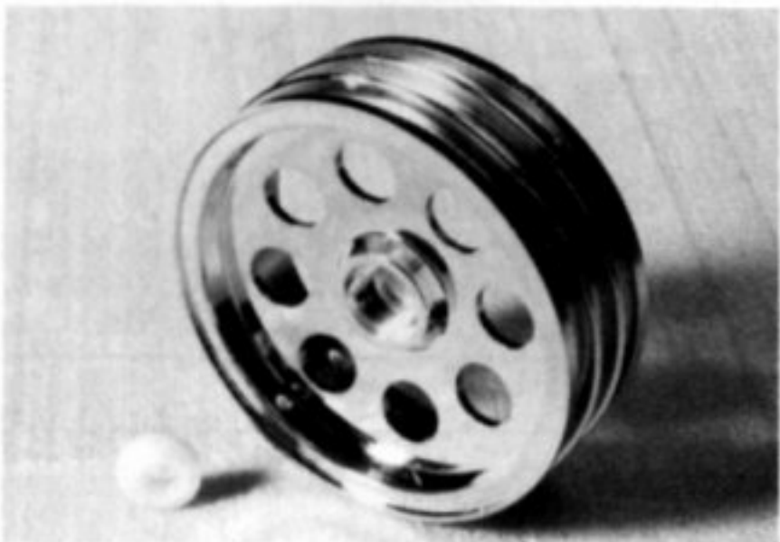
13. Les roues avant reçoivent des paliers en plastique blanc qui assurent de faibles frottements. Des roulements ne sont pas indispensables immédiatement.
