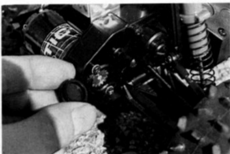
Une trappe permet de caler facilement le jeu interdent du pignon moteur.
