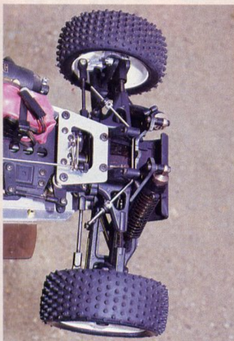
Le T.B.S.C.C. arbore le frein à disque à l'avant. Vous noterez le reste de l'équipement de ce train avant comme les cardans articulés et la barre anti-roulis. Ceci d'origine !
