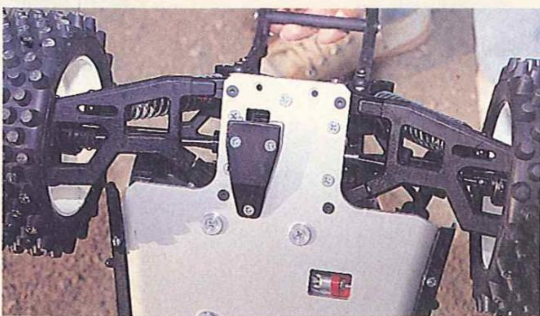
Les bavettes latérales, la protection de la couronne, le châssis fraisé, les excellentes vis... une foule de petits détails qui attestent de la qualité de l'ensemble.
