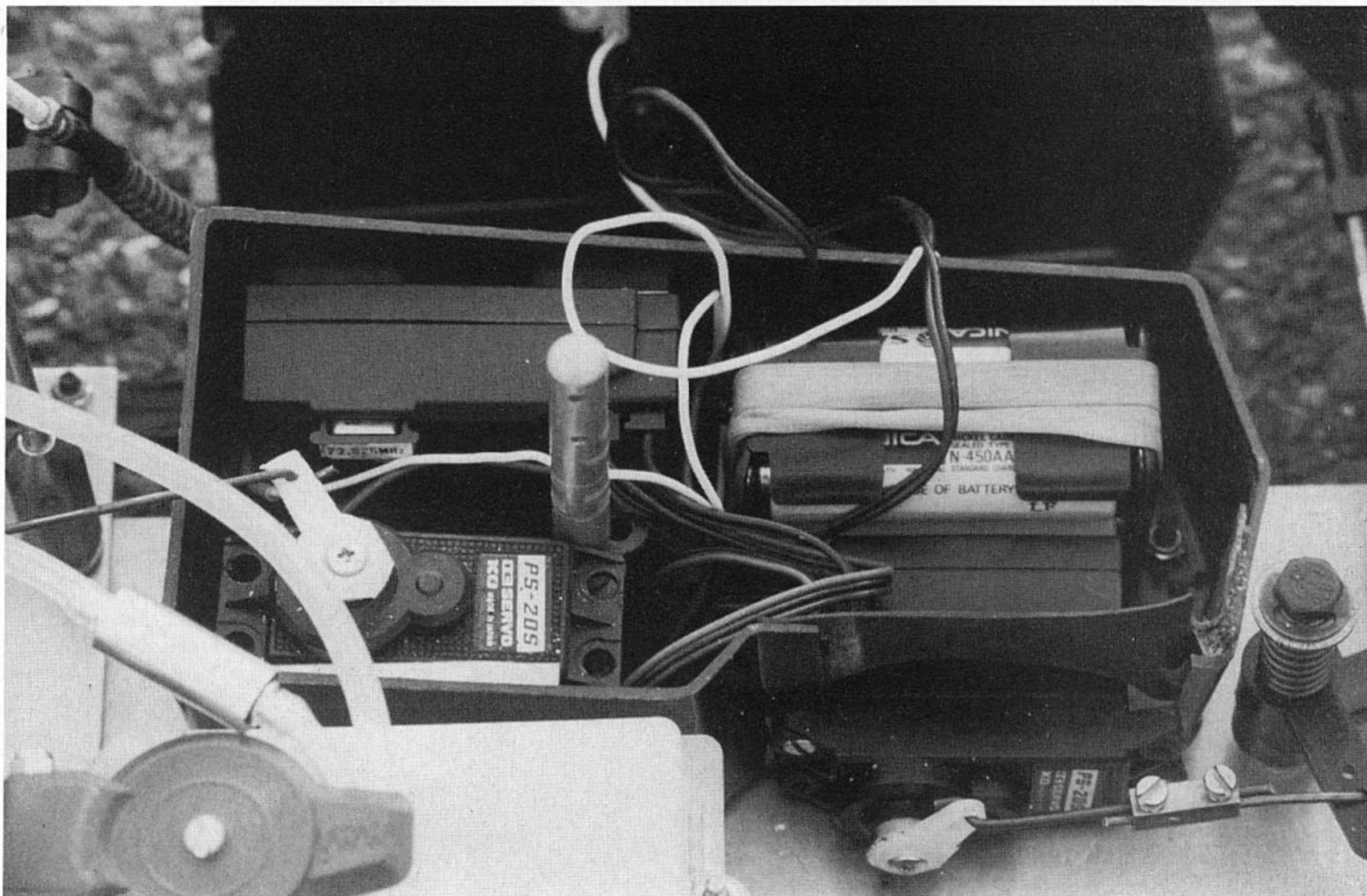
La boîte radio, bien que compacte, est très pratique. L'interrupteur de la radio sera fixé sur le couvercle.
