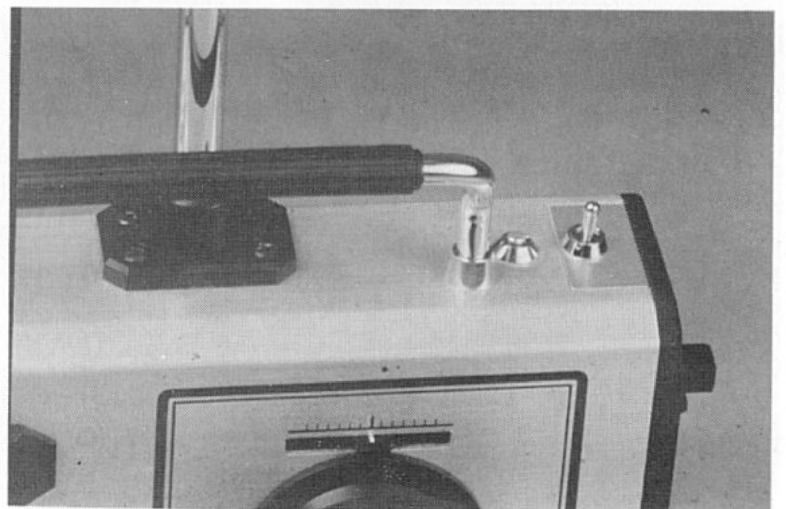
Le dual-rate peut-être neutralisé par l'inverseur et réglé, grâce au potentiomètre. Mais seulement avec un tournevis, ce qui est dommage.
