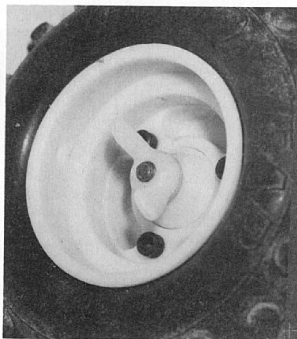
Une fixation de roue rapide et intelligente : l'écrou papillon.
