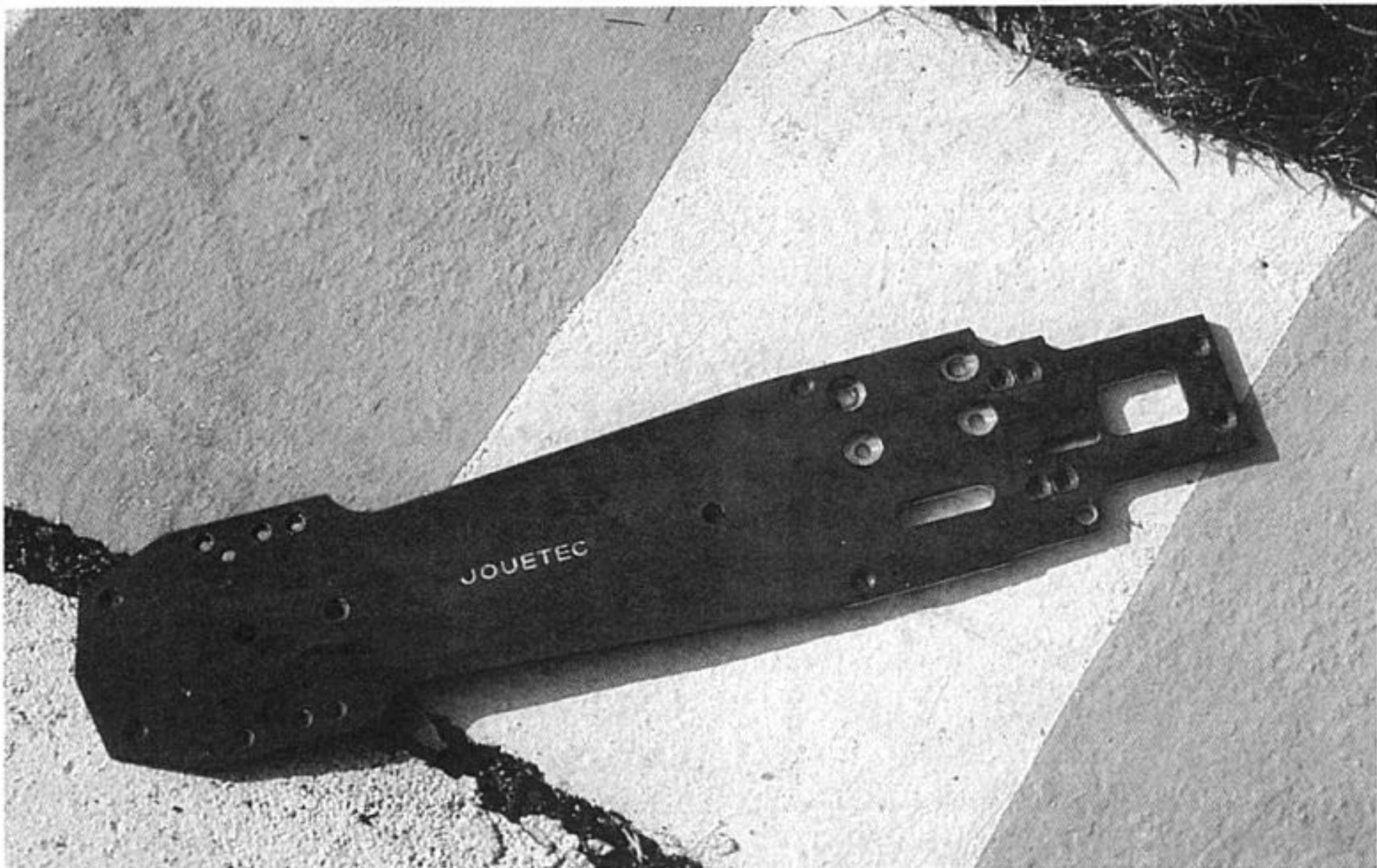
Le châssis « Jouetec » en carbone, avec la plaque moteur contre collée.
