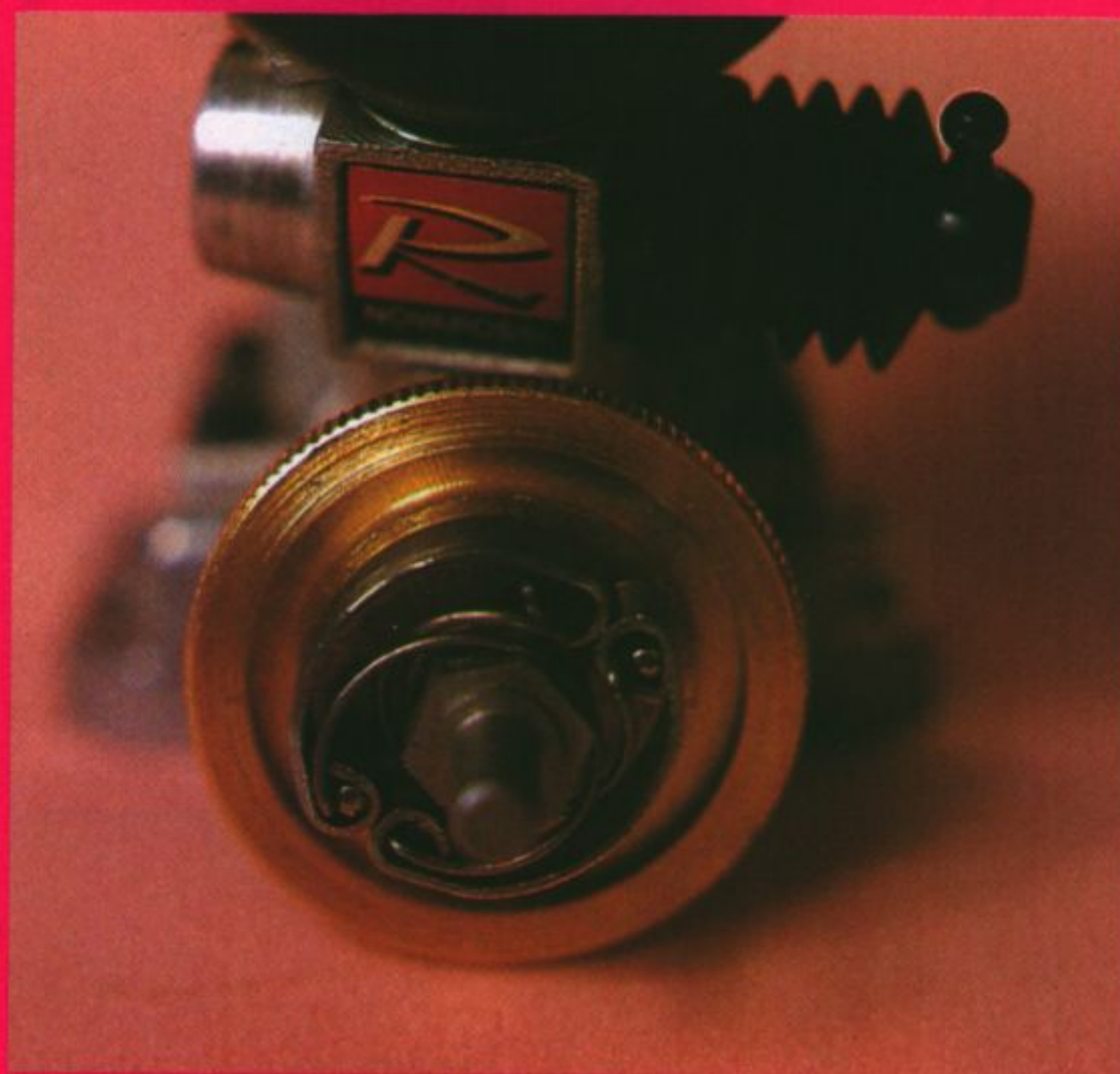
D'origine, les masselottes d'embrayage sont métalliques.
