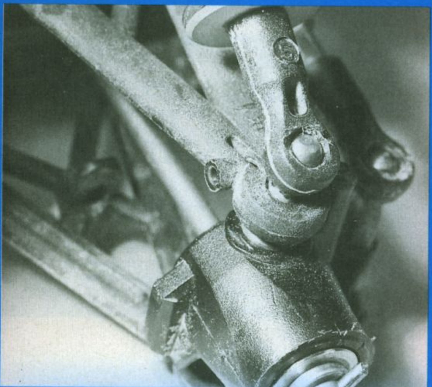
Fixations originales pour les triangles et les amortisseurs qui se voient encliquetés sur une double rotule (rotules superposées).
