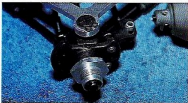
La fusée avant avec sa roue libre. Vous devinez également sur cette photo un des triangles proto en alu avec les 8 degrés de chasse.
