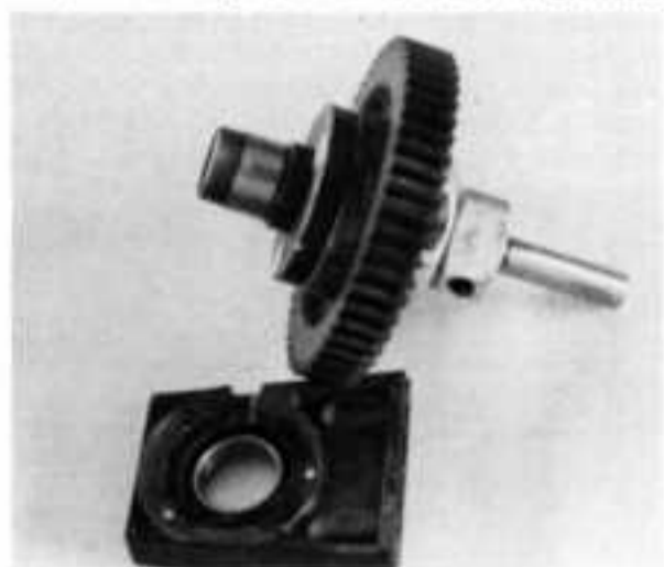
Le différentiel central reste à billes.
