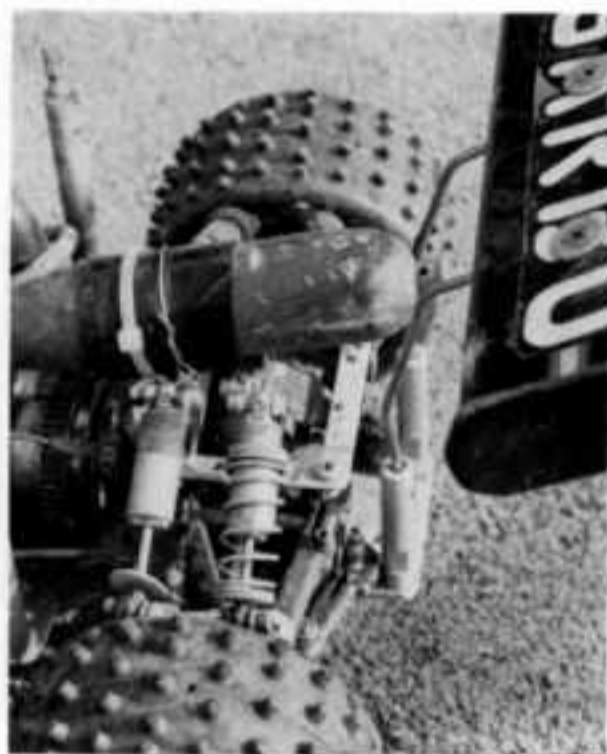
Un amortissement renforcé à l'arrière avec un hydraulique très ferme.
