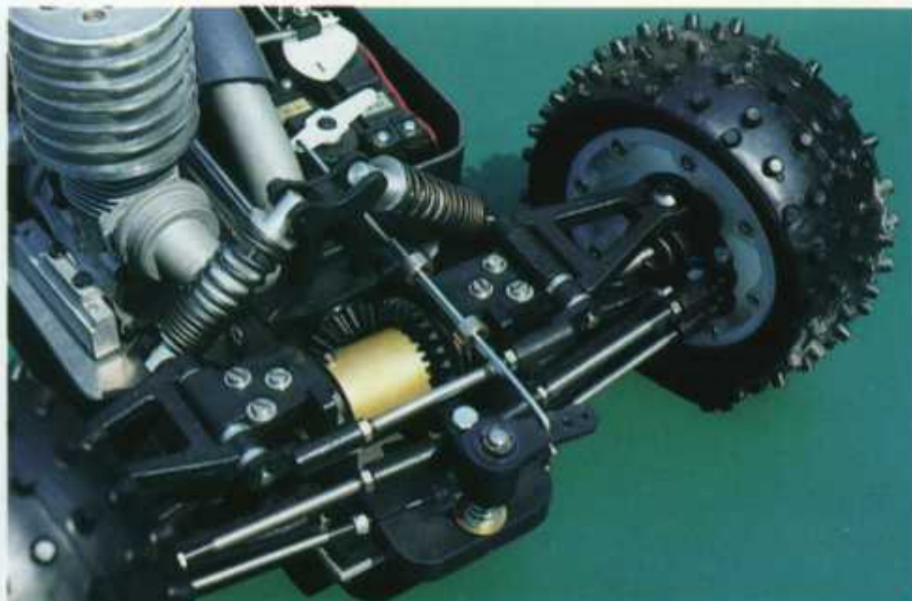
Un montage typiquement Devill : le servo est à l'extrémité frontale de la voiture et le couple conique (pignons plastiques) est à l'air libre.
