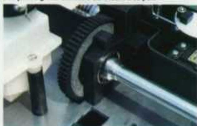
Autre particularité de la gamme Devill : la couronne sert aussi de disque de frein.
