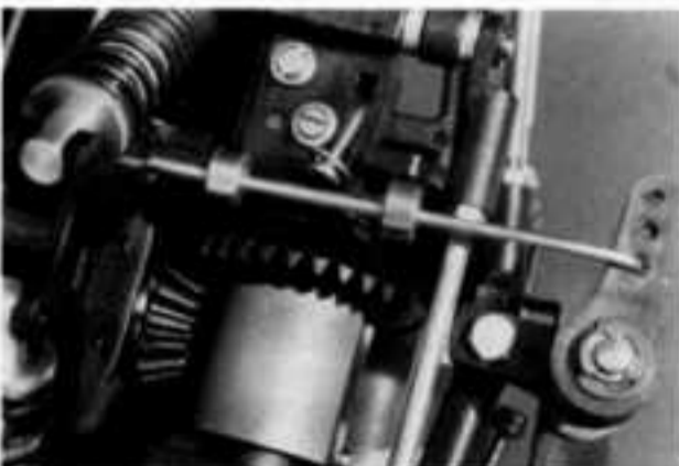
Le carrossage est réglable en faisant coulisser le triangle supérieur des suspensions. Une protection du couple conique est vivement conseillée.
