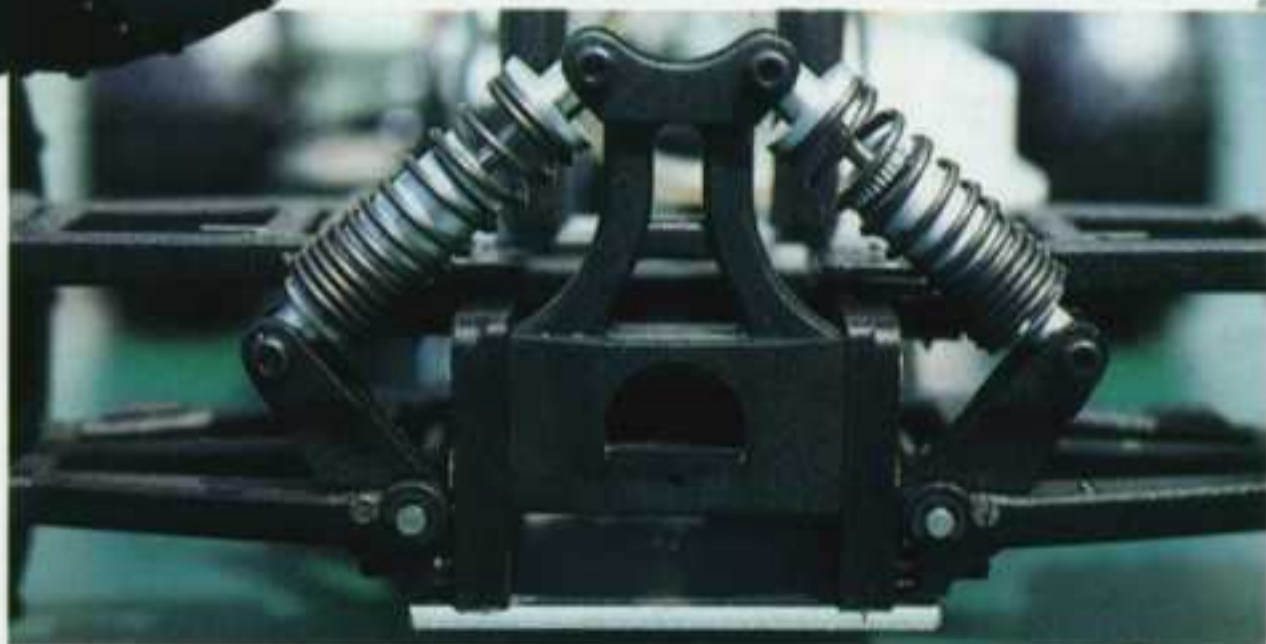
Un beau montage avec des basculeurs. Malheureusement, le réglage en dureté des ressorts n'est pas pratique.
