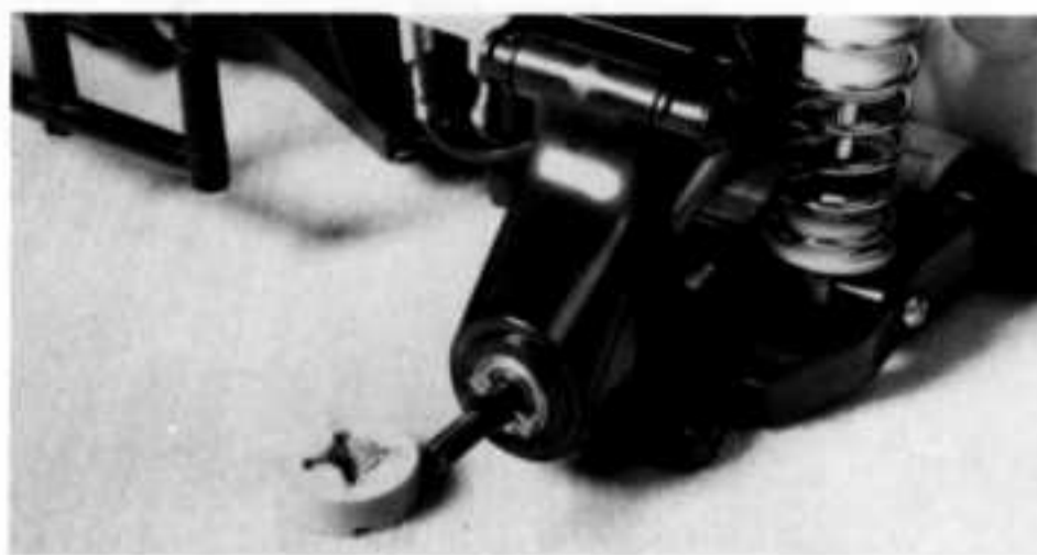
10. Bloquez les goupilles au moyen d'une petite goutte de colle anaérobie en prenant soin de ne pas en mettre sur le roulement. Ainsi vous ne risquez plus de les perdre en démontant les roues.
