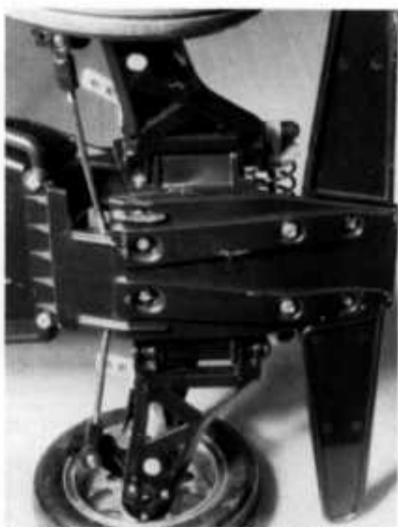
16. Le dessous de la coque est très bien protégé, ce qui est primordial en tout terrain. Mais ne serrez pas exagérément les vis.
