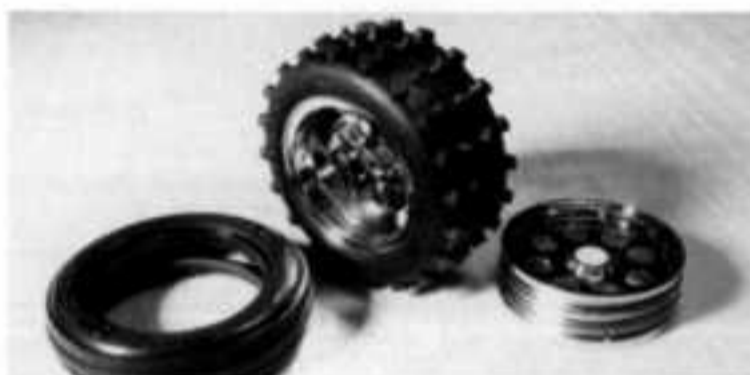
14. Les jantes sont dorées : la classe ! Les rainures permettent de bien maintenir les pneus et leur collage est secondaire. Mais attention au bon sens de montage des pneus arrière !
