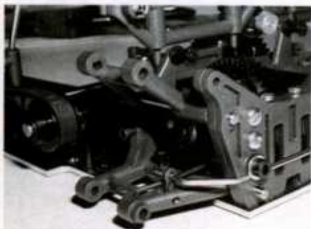
La barre anti-roulis est ancrée d'une manière mécanique. On distingue les vis de réglage des butées hautes et basses.
