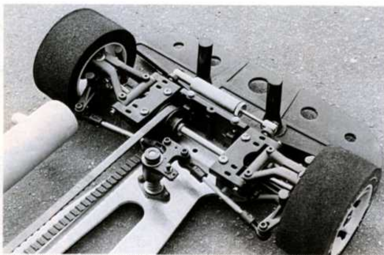
Le train avant dispose d'une multitude de réglage dont celui du carrossage. En plus toute la suspension est greffée sur le châssis.
