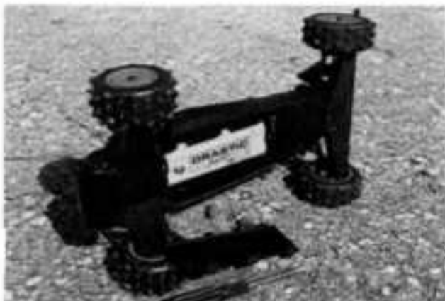
Les accus se logent sous le châssis dans le sens de la longueur. L'ouverture de la trappe nécessite l'utilisation d'un tournevis.
