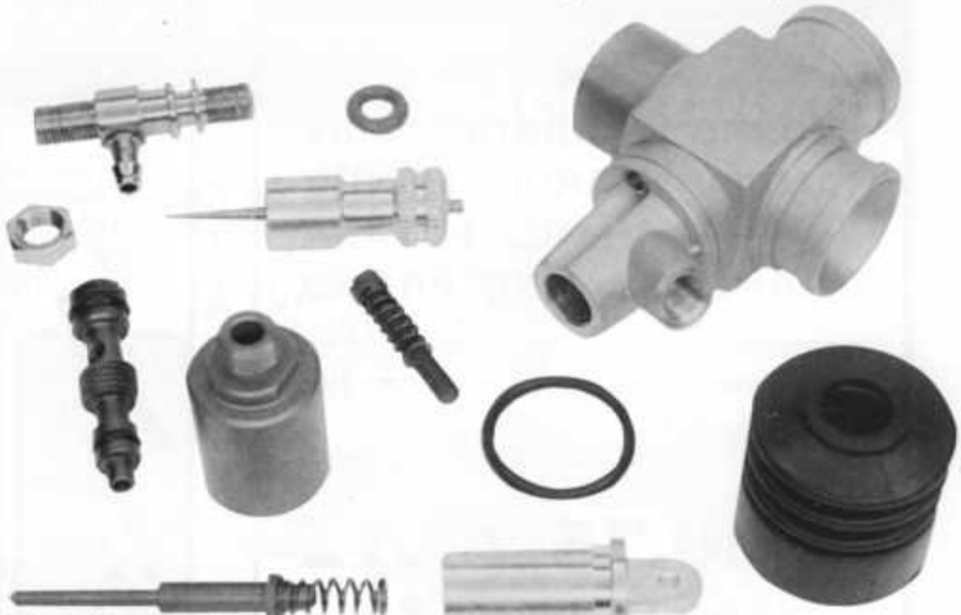
Ici en pièces détachées, le carburateur OS se montre stable et fiable en fonctionnement. Notez la bague en « plastique » afin que le carburant ne se vaporise pas.
