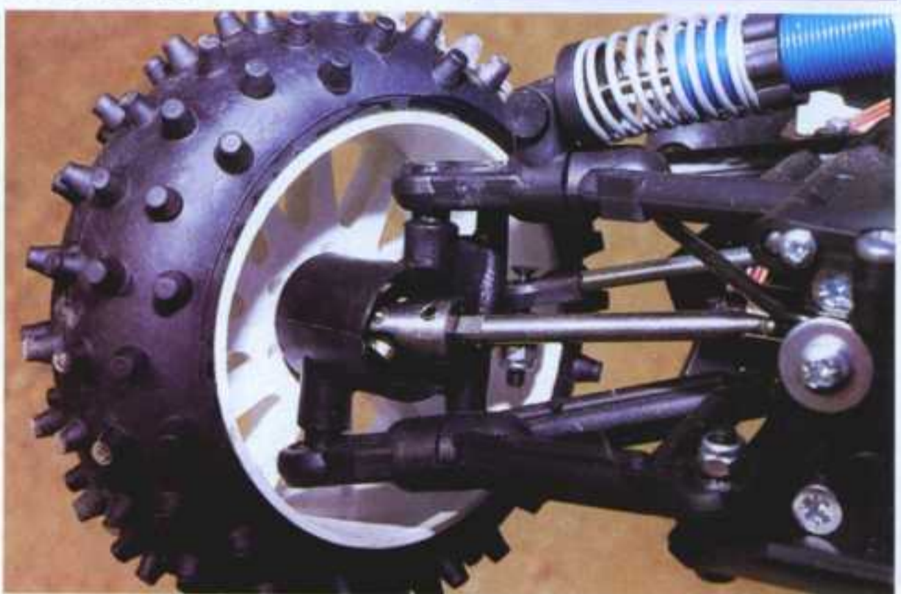
Les cardans sont articulés à l'avant. Les pneus d'origine s'avèrent très performants.
