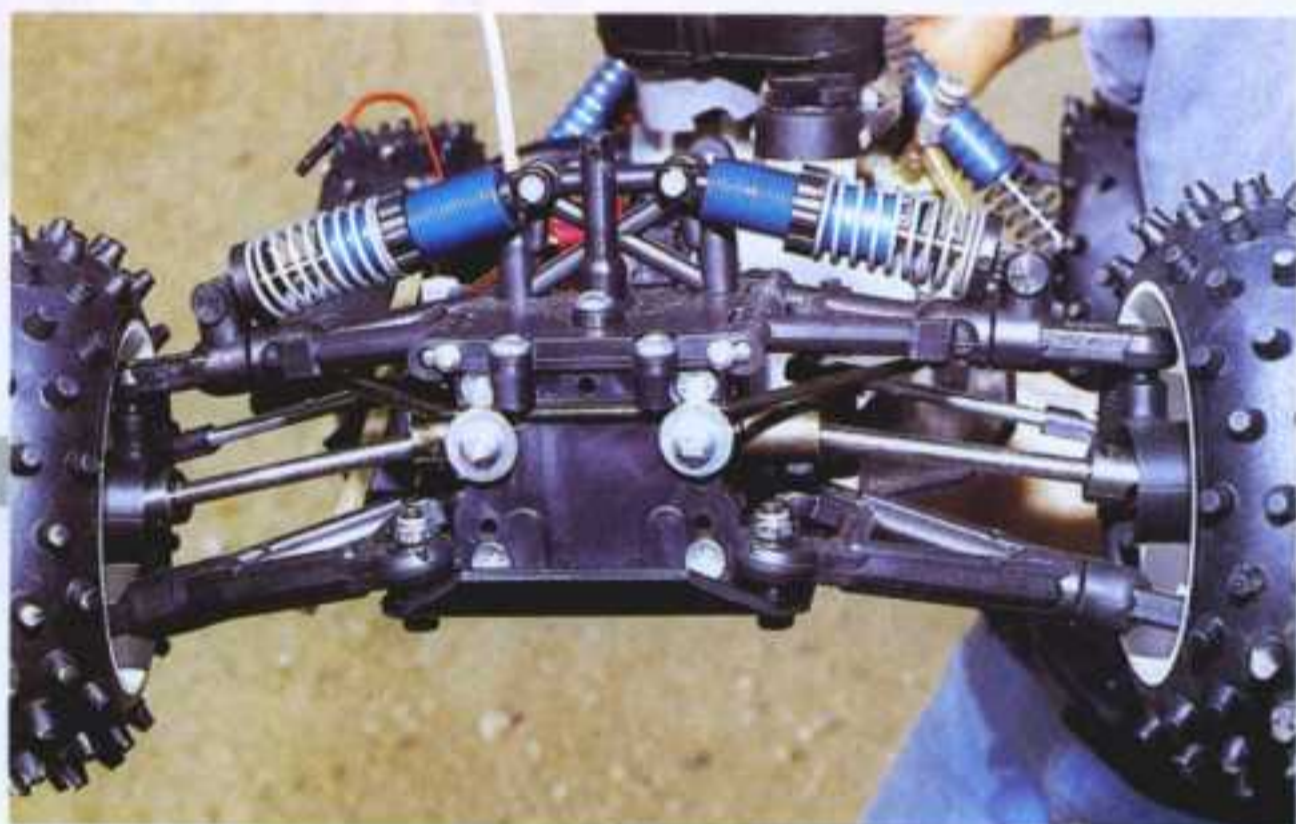
Une réhausse sur le train avant incline davantage les amortisseurs. Les triangles inférieurs sont montés sur rotules, les supérieurs sur des axes.
