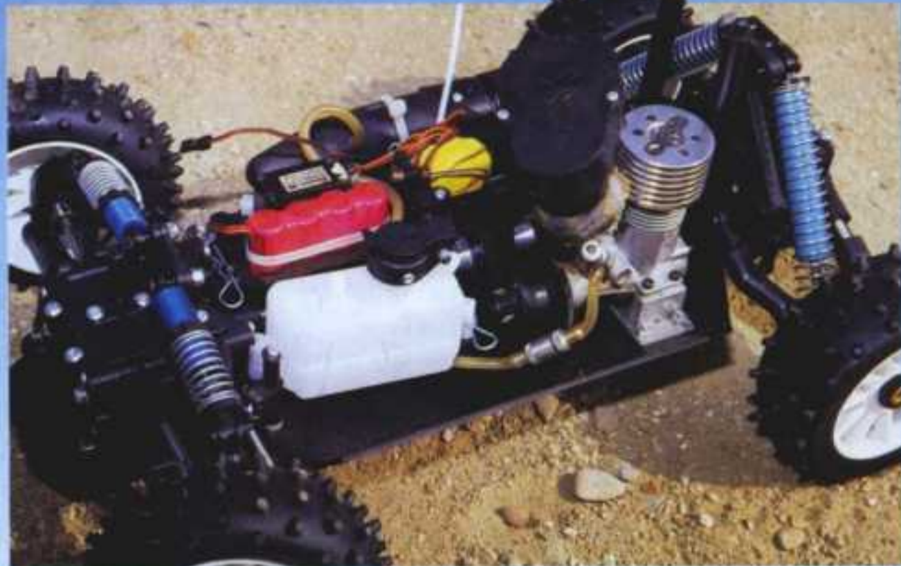
Dans la configuration OS à échappement latéral, le montage moteur ne pose aucun problème.
