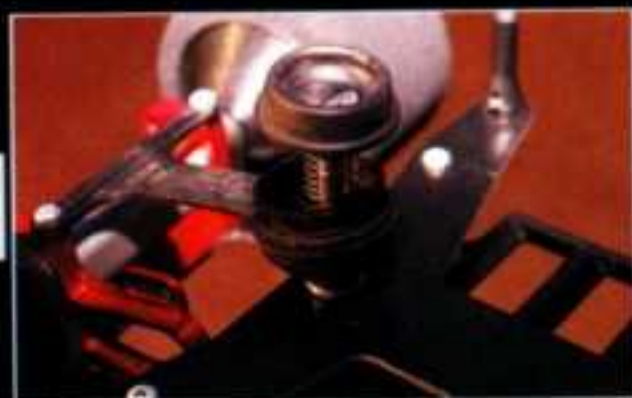
Les oscillations du train arrière sont contrôlées par un amortissement à friction, aidé en cela par une graisse épaisse.
