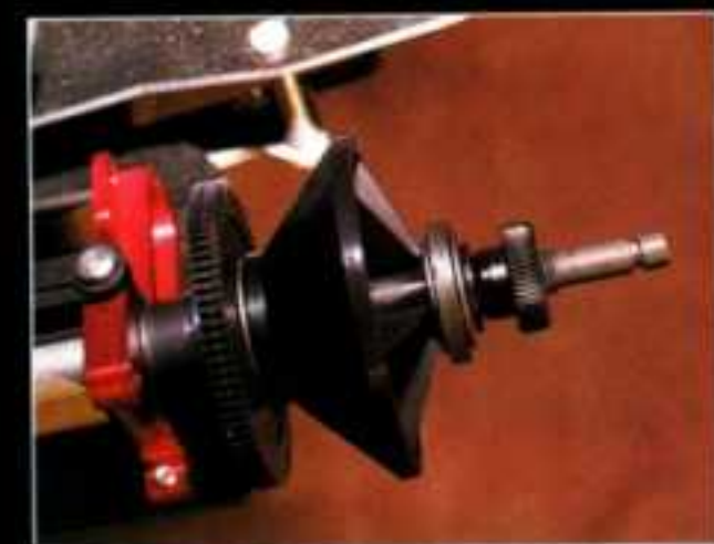
Le différentiel à billes est un vrai bijou. Les flasques internes chers à Corally guident les jantes on ne peut mieux.
