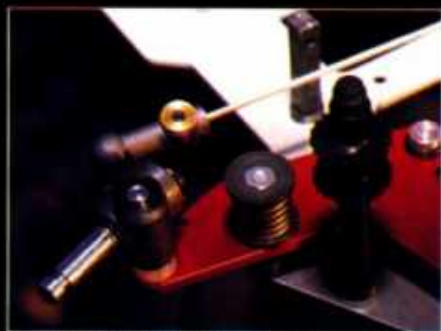
Les démontages des jantes, des fusées se fait en un tour de main grâce aux clips en plastique démontables. Dans les fusées, les roulements sont conservés pour les axes de roues mais disparaissent des pivots.
