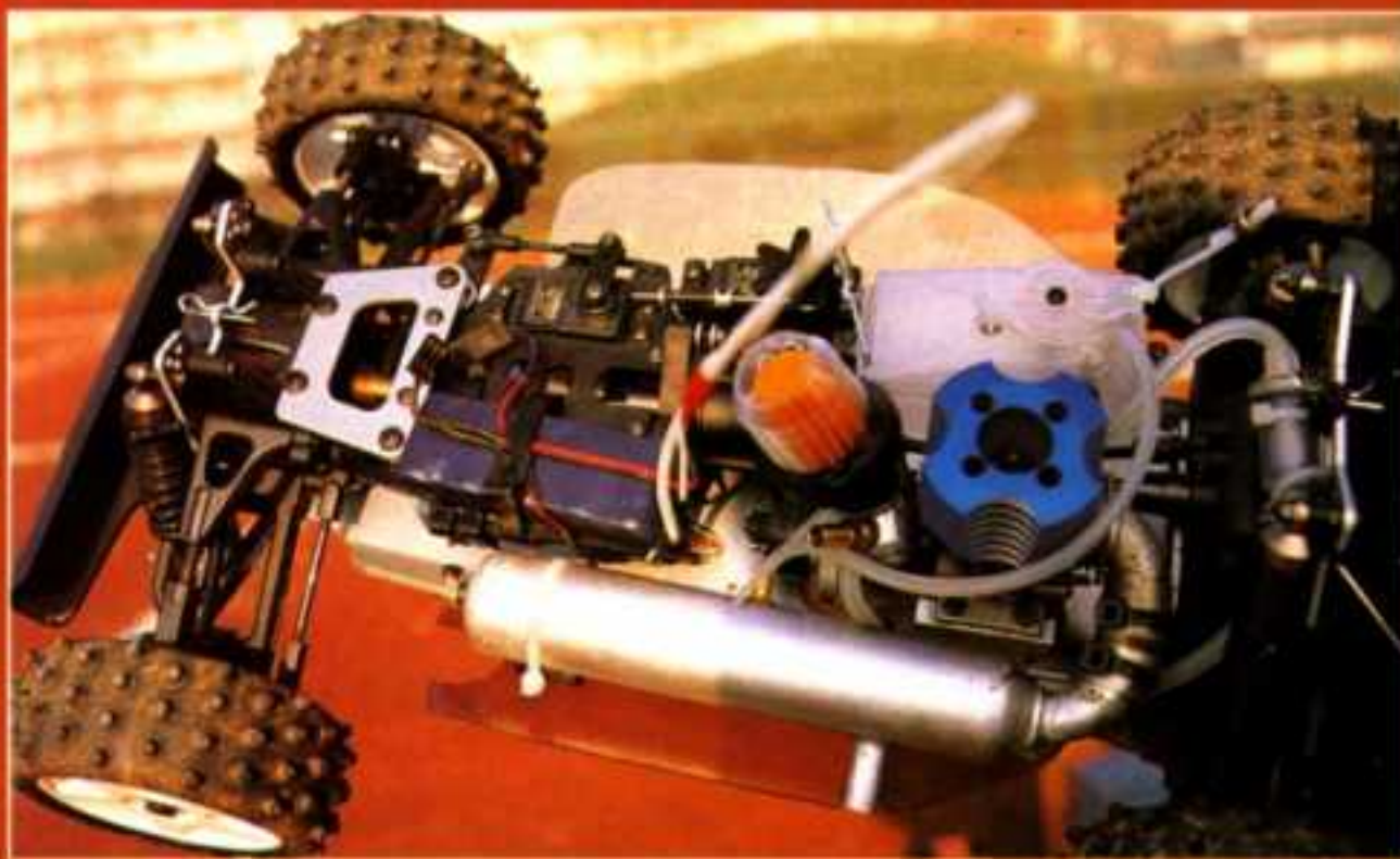
L'empattement a été porté au maximum sur le Turbo Burns. Vous remarquerez le nouveau pot d'échappement et les bavettes latérales en lexan.
