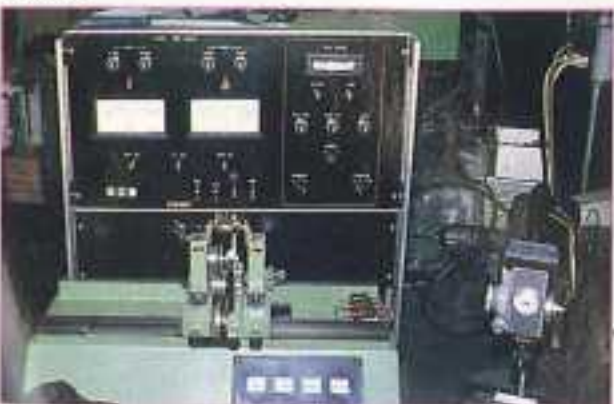
Les induits sont équilibrés sur cette superbe machine. L'équilibrage se fait par percage, la perceuse se trouvant sur la droite de notre photo.
