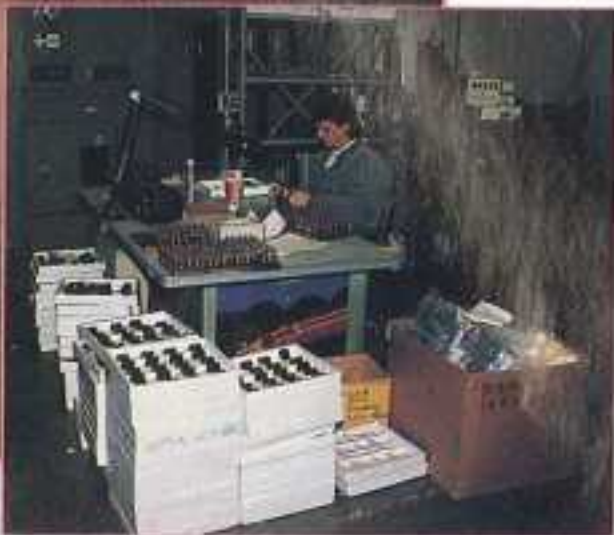
Une fois les collecteurs rectifiés et les induits équilibrés, les moteurs sont assemblés dans cet atelier.
