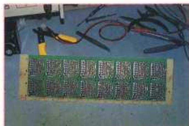
Les circuits imprimés des variateurs électroniques sont prêts à recevoir les différents composants.
