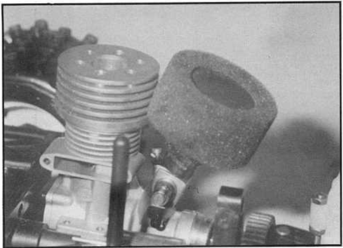
Un gros cube aussi, l'OS 40 4 temps : moins de puissance, mais un couple omniprésent et un bruit beaucoup plus réaliste.
