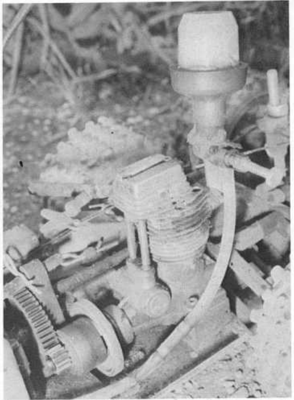
Un gros cube aussi, l'OS 40 4 temps : moins de puissance, mais un couple omniprésent et un bruit beaucoup plus réaliste.
