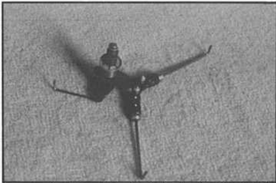
Le sauve-servo. Notez la tringle très simple qui le relie au servo.
