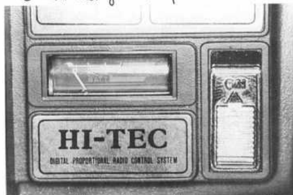
Le VU-mètre indique l'état des piles
