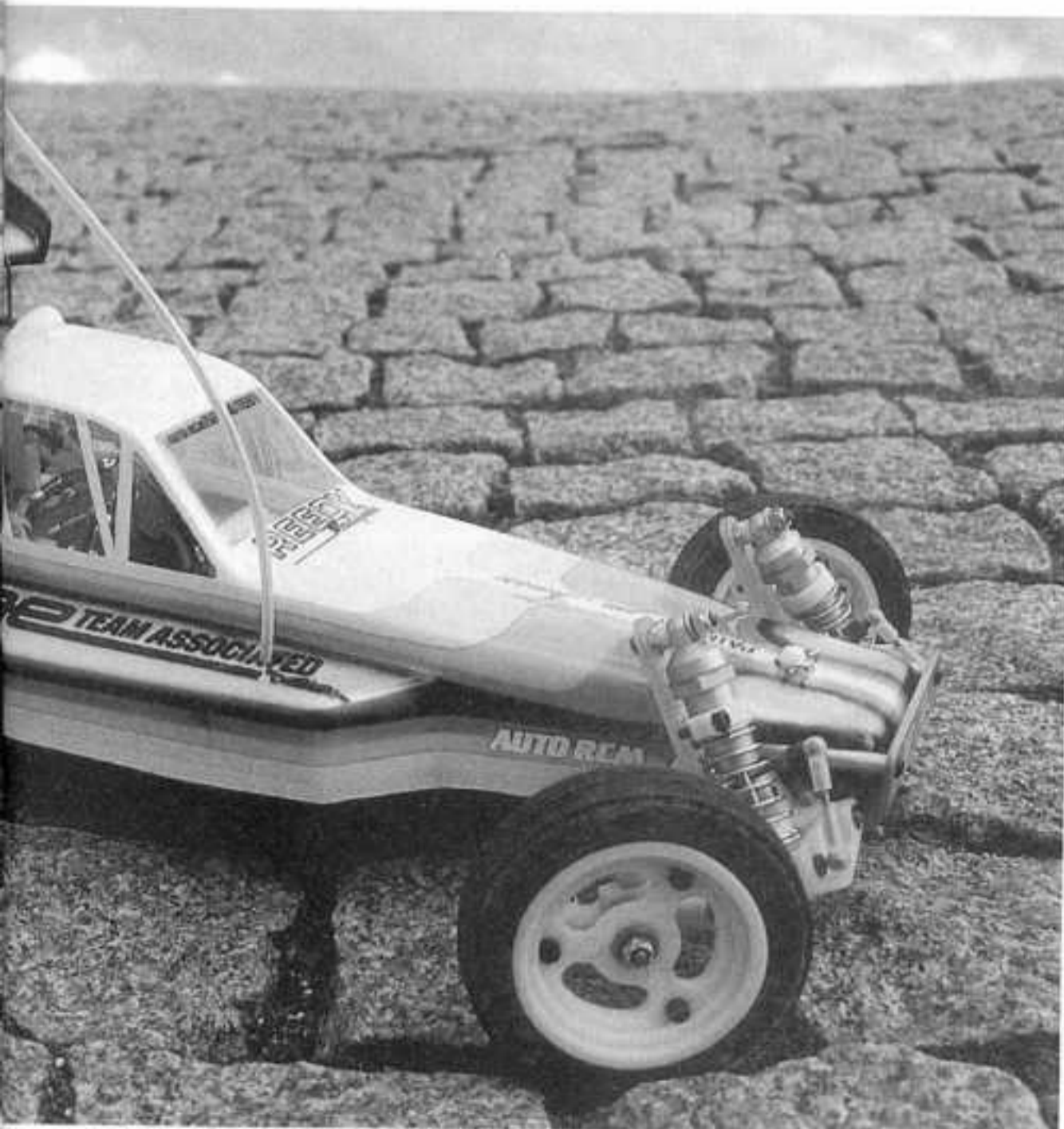
Une fixation de roue rapide et intelligente : l'écrou papillon.
