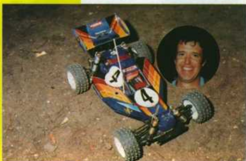
Un 4x4 de chez Nichimo avec moteur central "avant" et longitudinal.
