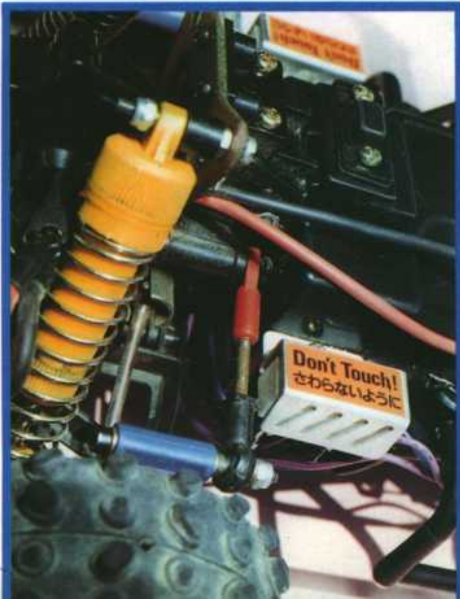
Train arrière vu de devant monté avec les nouvelles pièces Boomerang et les tirants de carrossage réglables.
