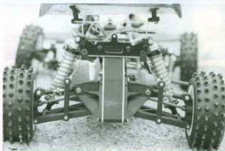
Notre MRX dans sa configuration compétition avec corps d'amortisseurs en alu doré et barre anti-roulis arrière.
