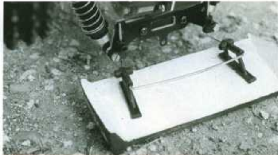
Le support d'aile en corde à piano, sera plié à la demande et fixé sur le support d'amortisseurs en époxy.
