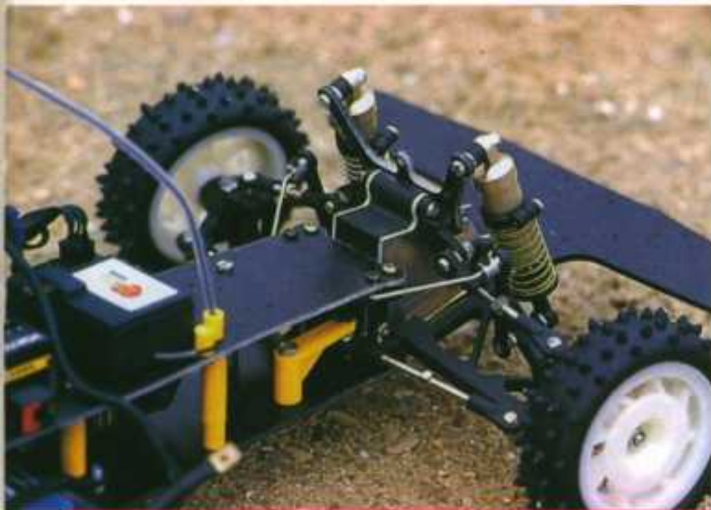
A l'avant, amortisseurs courts «compétition» et barre anti-roulis. Le servo et le variateur de vitesse mécanique ont été remplacés par un variateur électronique.
