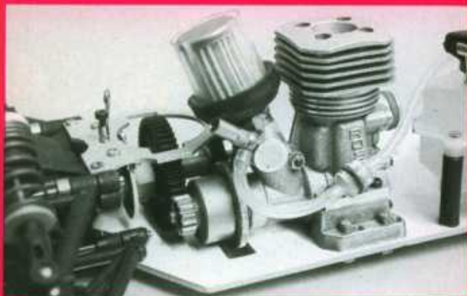
Vu la position du moteur sur le Runner, à côté de la boîte radio, il sera nécessaire, si vous utilisez comme nous un NOVA ROSSI, d'utiliser un coude de la même marque, et de refaire une prise de pressurisation (celle d'origine étant inutilisable vu sa position).
