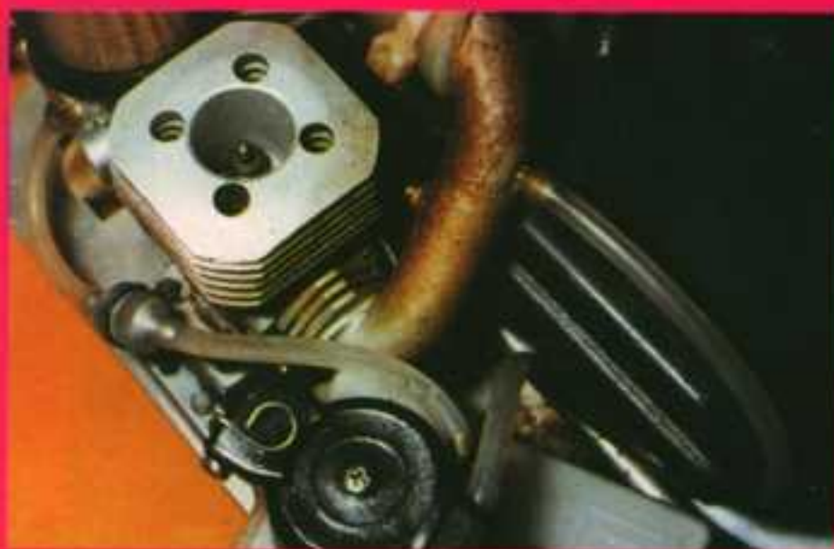
Vu la position du moteur sur le Runner, à côté de la boîte radio, il sera nécessaire, si vous utilisez comme nous un NOVA ROSSI, d'utiliser un coude de la même marque, et de refaire une prise de pressurisation (celle d'origine étant inutilisable vu sa position).
