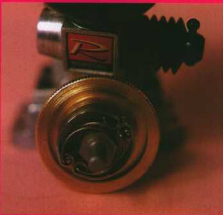
D'origine, les masselottes d'embrayage sont métalliques.
