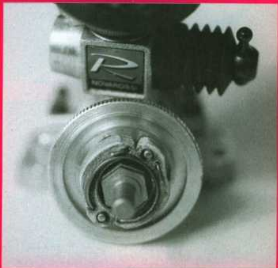
D'origine, les masselottes d'embrayage sont métalliques.
