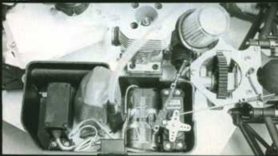
Toute la partie radio, y compris les servos, sera protégée dans une boîte radio.
