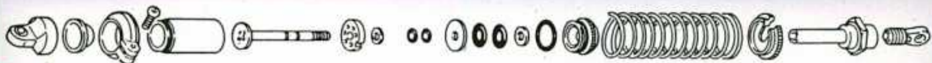
Schéma d'un amortisseur «Platinum»
