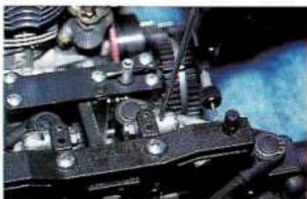
Après serrage des amortisseurs arrière, il faut veiller à bien réaligner à l'aide d'un petit tournevis la fixation supérieure.
