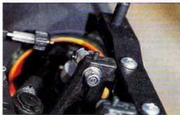
La garde au sol sera réglable grâce à ces trous oblongs prévus dans les paliers arrière.
