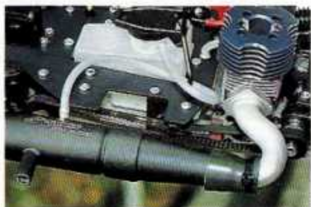
La courroie intermédiaire passe sur la gauche de la voiture. Elle s'appuie sur un roulement qui fait office de tendeur.
