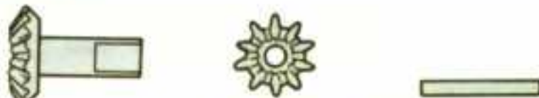
⑳ベベルギヤA 4ヶ ㉑ベベルギヤB 4ヶ ㉒ベベルシャフト 2ヶ
