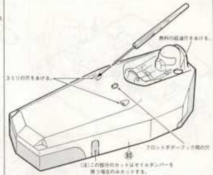
43 ボデー線をカッターラインにしたがいカットし、ドライバーガード取付穴をキリ等であけて下さい。
