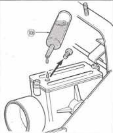
20 Getriebewartung Vor Inbetriebnahme muß der Getriebekasten mit ca. 5 ccm Motorenöl gefüllt werden. Alle gleitenden Teile müssen ebenfalls geölt werden. Überflüssiges Öl tropft automatisch aus dem Getriebekasten heraus. Vorsicht, es können Ölflecken auf dem Untergrund entstehen.
