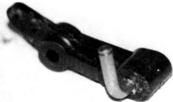
De nouvelles fusées sont apparues récemment dans lesquelles les axes de roues sont inclus lors de l'injection ; la fixation des roues avant s'effectue désormais à l'aide de nylstops. En outre, la géométrie a été revue et l'axe de roues se trouve du côté opposé à la rotule de direction, par rapport à l'axe de la fusée. Cette configuration procure à l'Enduro une tenue de route agréable et précise sur les terrains peu adhérents.
