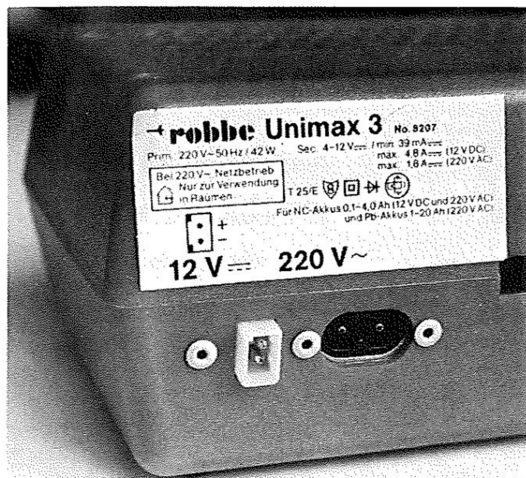
Gros avantages de l'Unimax 3 : il permet la charge à partir du 220 V ou du 12 V.
