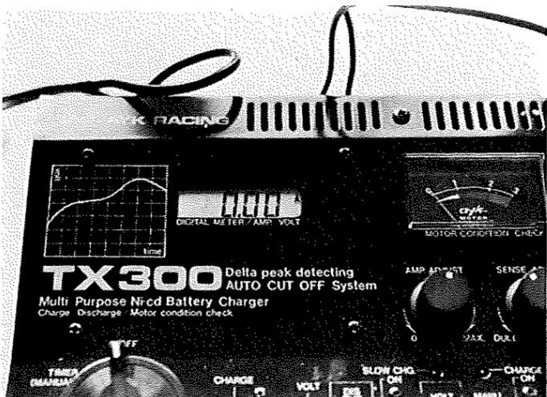
Voltmètre, ampèremètre digital et vue-mètre de contrôle du motor-checker.
