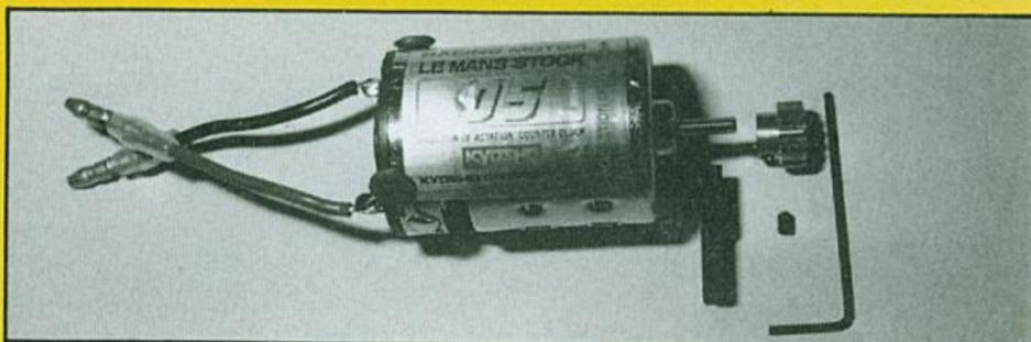
Pour le montage du pignon moteur une petite cale sera utilisée pour obtenir un bon calage d'attaque de la cascade de pignons. Le rapport sera de 14 dents pour le moteur (on peut voir en détail le montage du pignon sur le moteur à l'aide de la cale et de la clé BTR livrée dans le kit).
