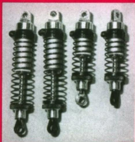
On peut voir nos amortisseurs sur cette photo et on découvre leur différence de longueur (court pour l'avant et long pour l'arrière). On peut également voir une molette sur leur partie inférieure, qui sert à changer la dureté de l'amortisseur à la compression.
